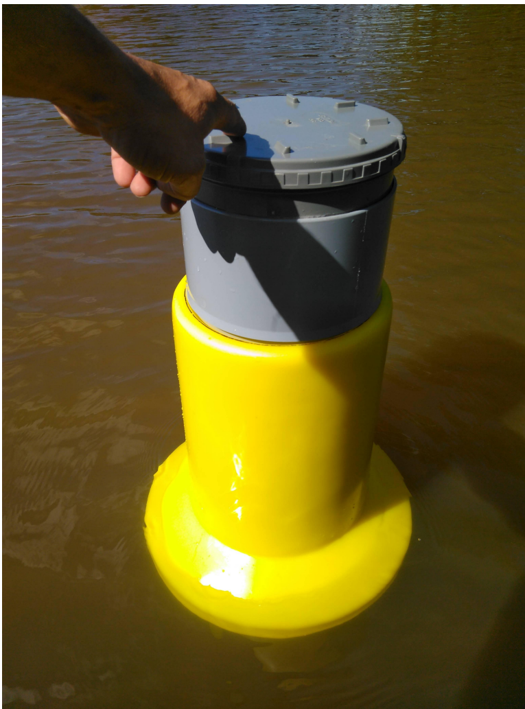
Figuur 7. Eerste prototype van de behuizing voor een drijvend Batcorder systeem. In deze boei kan de recorder worden geplaatst. De microfoon en zonnepanelen kunnen aan de buitenzijde worden geplaatst.
