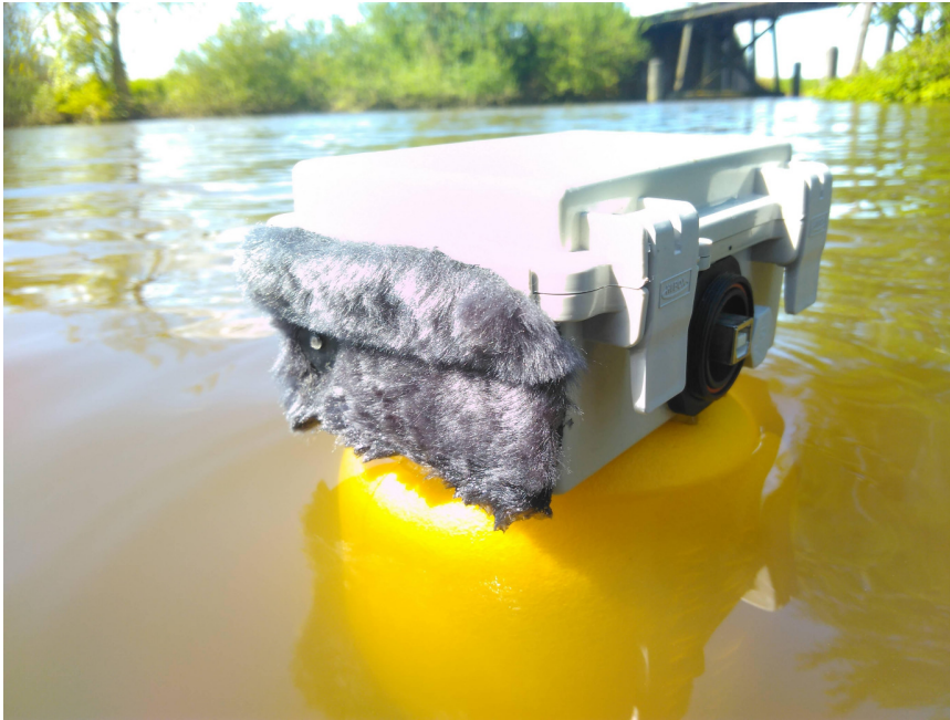
Figuur 8. Prototype van een drijvende Batpi met een ingebouwde Pettersson M500 microfoon. Bij dit prototype is gekozen voor de Pettersson M500 met Knowles FG electret microfoon in plaats van een Dodotronic microfoon omdat de Dodotronic microfoon in de praktijk vochtgevoeliger is dan de Knowles FG electret microfoon. De Knowles FG electret heeft zich ook bij het Batcorder systeem in offshore projecten als relatief robuust bewezen.
