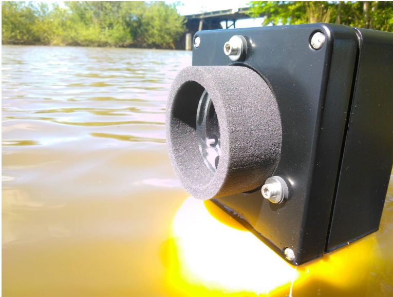
Figuur 6. Eerste prototype van een drijvende Batcorder microfoon
