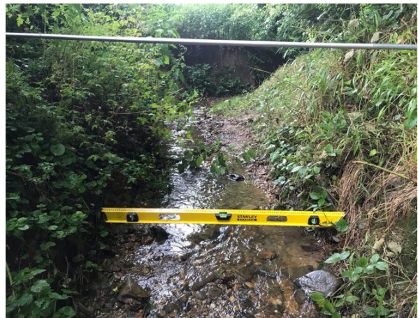
Handmeting dwarsprofiel SV6.3 13-7-21
