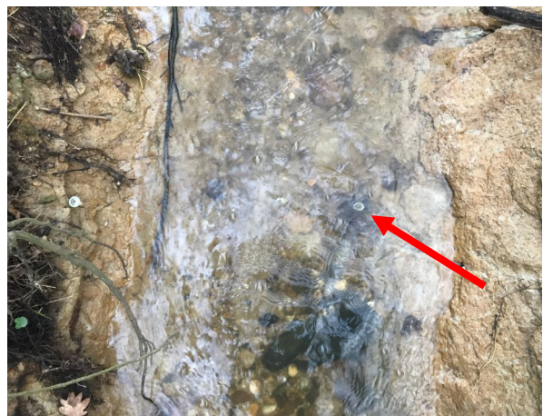
Erosie 37 mm bij bout B41 in 1 e raai bij SV5
