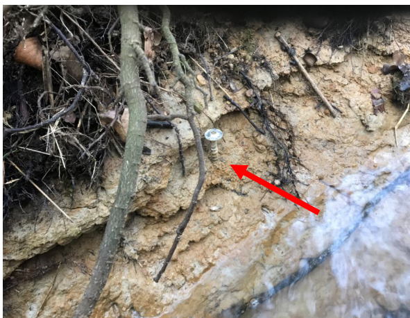
Erosie 60 mm bij bout B33 in 1 e raai bij SV5
