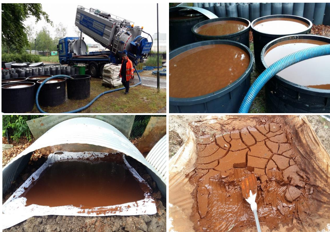
Figuur 6.3: Verwerking van het ijzerkalkwater tot steekvast drinkwaterslib dat is toegepast in de veldexperimenten.
