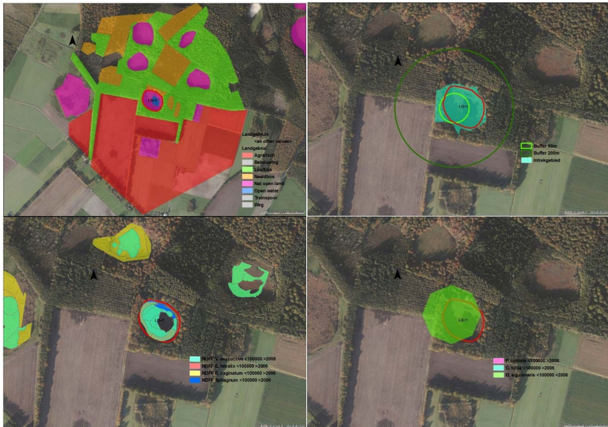
Afbeelding 3-2: Voorbeelden van de aanpak in GIS aan de hand van een voorbeeldveen LB+1. Linksboven staan de landgebruikstypen, met in het midden het veentje (roodomrand). Het landgebruik is ingetekend in een buffer van 500m rond de buitenkant van het veen. De open stukken betreffen "Droog natuurlijk terrein". Rechtsboven staan de buffers rond het meetpunt (50m en 200m) en het intrekgebied zoals gebruikt in hoofdstuk 4. Linksonder staat de verspreidingsdata van plantensoorten aangeleverd door de NDFF en rechtsonder staat de verspreidingsdata van de doelsoorten.
