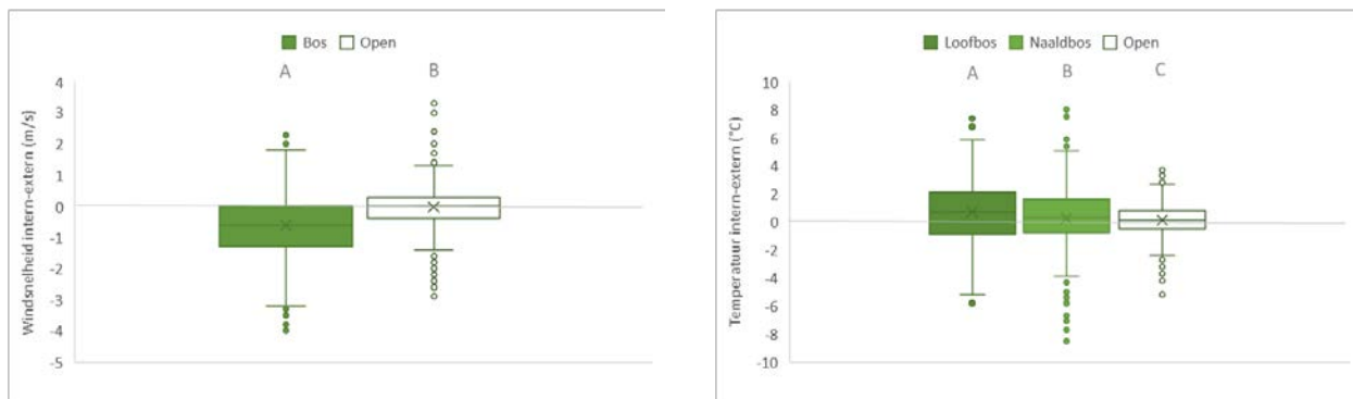
Figuur 4-11: Verschil in windsnelheden (links) en temperatuur (rechts) tussen de plotmeting en een referentiemeting in het open veld in open en bosplots.
