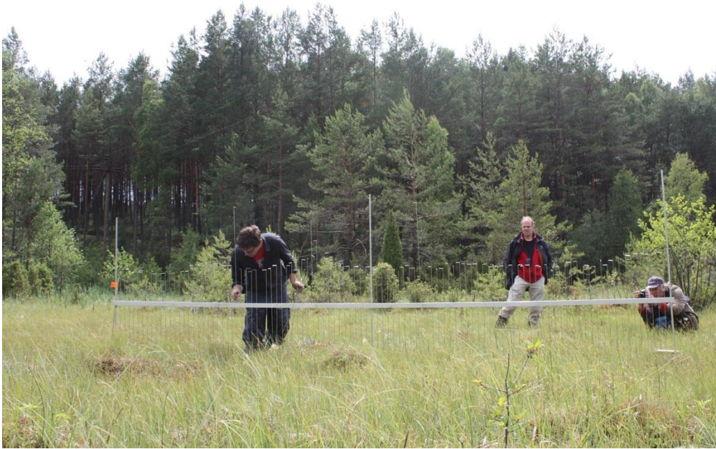
Foto 1: Het pinframe van 5 m lengte waarmee de microtopografie in de transecten van 10 meter is gemeten.
