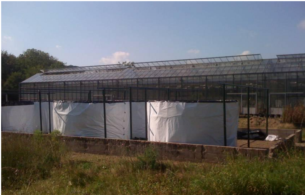
Foto 3: Opstelling voor het predatie-experiment. Om opwarming van de tanks te beperken zijn ze bekleed met witte folie.
