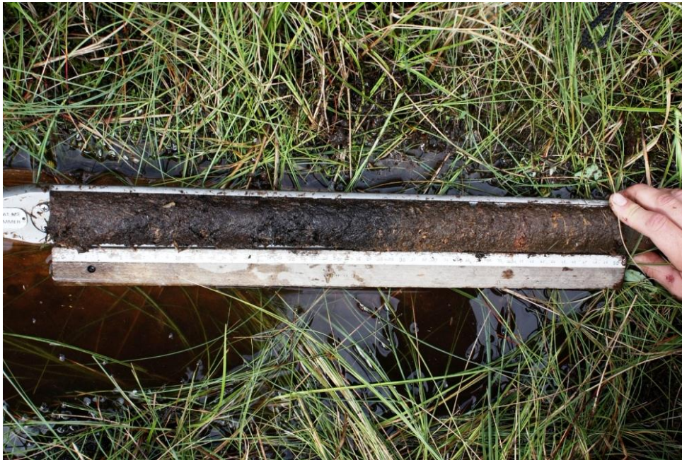
Foto 10: Met de Russische veenboor kunnen relatief intacte veenprofielen worden uitgestoken tot op vele meters diepte.
