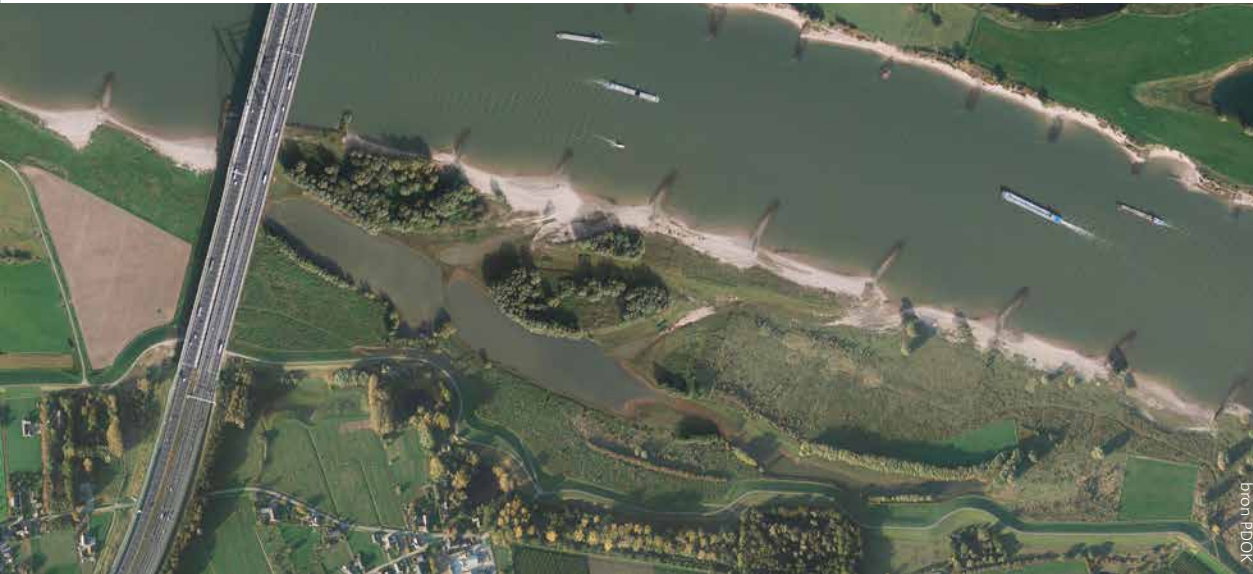
Figuur 16 Luchtfoto van de Ewijkse Plaat in 2020. Zichtbaar zijn de dwarsgeulen die in 2010 door het oobos zijn getrokken als maatregel 'cyclische verjonging', waarbij een deel van het bos is blijven staan op tijdelijke (schier)eilanden.
