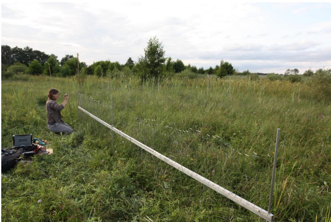
Foto 2-2: Opname van de maaiveldhoogte met een pinframe.
