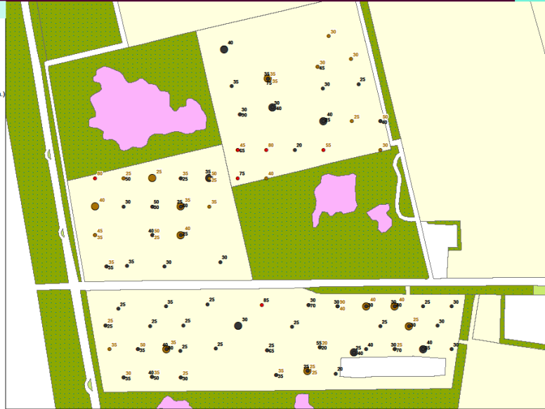
Figuur 5: Tijdens het voorbereidend onderzoek van de Provincie Limburg via grondboringen aangetroffen slecht doorlatende veen- en leemlagen.
