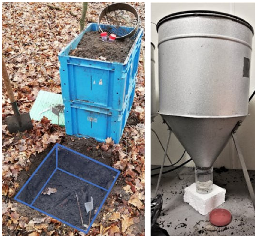
Figuur 4.25. De top laag, bestaande uit de bovenste 5 cm van de ectorganische laag en minerale bodem, is bemonsterd met behulp van een springvorm en meegenomen naar het laboratorium voor extractie in een tullgren-trechter (rechts), waarna de macrofauna uit de daaronder liggende lagen over een oppervlakte van 50x50 cm tot een diepte van maximaal 25 cm op locatie is gesorteerd met behulp van een zeef boven een bak.
