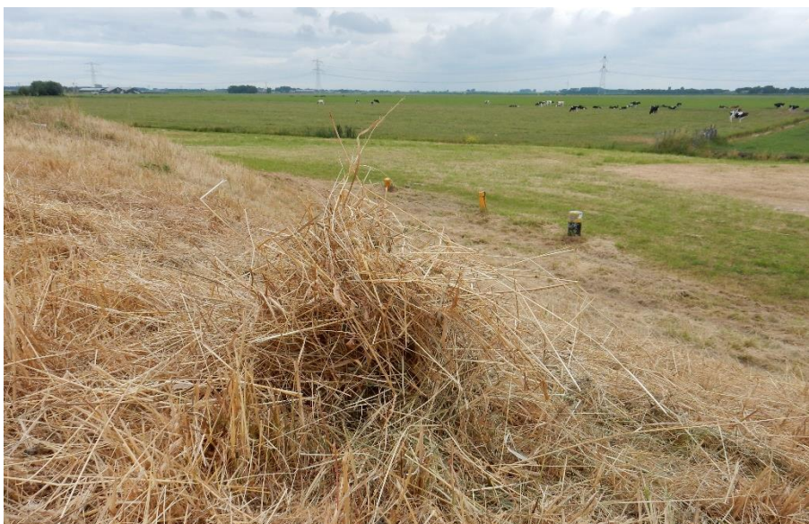
Figuur 9: In proefvlak S1 is het sinusbeheer op een groot deel van het proefvlak (achtergrond van de foto) niet uitgevoerd. Bovendien is het maaisel op het talud onvolledig afgevoerd (voorgond). Dit beïnvloedt de resultaten van het experiment negatief. Foto Anthonie Stip.
