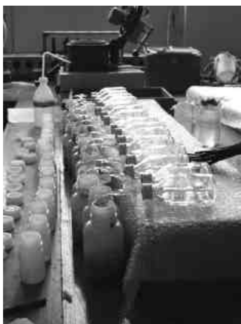
Figuur 4.3 Lactaatextractie voor het bepalen van biologisch beschikbaar fosfaat in de bodem.
