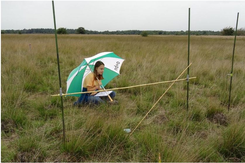
Figuur 2.5: Veldopstelling voor het opmeten van vegetatiehoogte en microreliëf na drukbegrazing in SA (boven). Voorbeeld van het verloop van vegetatiehoogte en microreliëf langs de 50 dm-punten van een transect in de controle van blok KA (rechts). Field set-up for measuring vegetation height and microtopography after intensive rotational grazing in SA (above). Example of variation in vegetation height and microtopography along 50 dm-points of a transect in a control plot of block KA (right).
