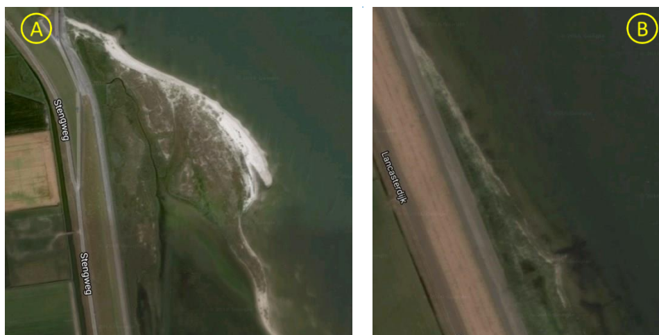
Figuur 6 Recente luchtfoto's (augustus 2016) van (A) kwelder De Volharding bij De Cocksdoorp en (B) de noordelijke punt van De Schorren. Aan de kleur is duidelijk te zien dat de kwelder De Volharding profiteert van de aanvoer van vers (licht gekleurd) zand/schelpen, welke aanlanden aan de noordzijde en daar een actieve strandwal vormt waardoor de kwelder kan groeien. Op dezelfde luchtfoto is op kwelder de Schorren ook vaag een zandwal te zien. Deze oogt echter niet actief (grouw, geen actief 'spit'), maar eerder erosief. De vraag is ook of deze zandwal een natuurlijke oorsprong heeft, er lijkt geen zandaanvoer vanaf het voorliggende wad op te treden (foto's van Google Earth).
