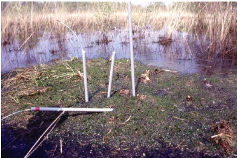
Figuur 3.1: Met behulp van keramische cups wordt op verschillende diepten onder vacuüm bodemvocht verzameld. Op deze foto wordt gemonsterd in een recent ontstane drijftil in de Mariapeel.
